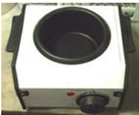
Fig. 1 (sopra): Bagnomaria elettrico per fondere la paraffina.
