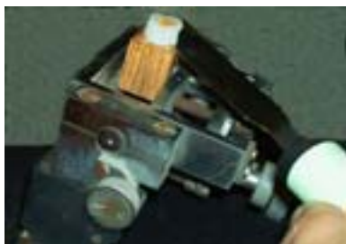
Fig. 4: Modo di “incollare” il blocchetto di paraffina sul supporto per il taglio.
